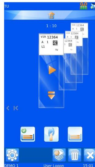
En appuyant une fois sur le bouton "lame par lame", vous déplacez la lame vers la gauche dans la file d'attente. L'imprimante commence systématiquement par imprimer la lame située au premier plan, avant de passer aux lames de droite, puis à celles de gauche.
