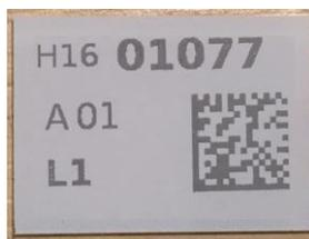
**Impression trop claire.** Une impression systématiquement trop claire tient à une chaleur insuffisante ou à l'utilisation de lames non compatibles avec l'impression thermique (lames pour imprimante à jet d'encre). Augmentez la chaleur pour améliorer la qualité d'impression.
