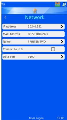
Si la connexion au réseau réussit, une adresse IP s'affiche dans le champ Adresse IP. Lorsque le réseau est configuré pour attribuer automatiquement les adresses IP et que le type d'adresse IP est défini sur DNS, une adresse IP s'affiche.
