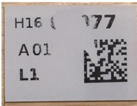
**Manques aléatoires.** Ces "blancs" sont liés aux irrégularités de la surface de la lame. Il se peut que vos lames soient de mauvaise qualité, défectueuses ou non compatibles avec l'impression thermique (lames pour imprimante à jet d'encre).
