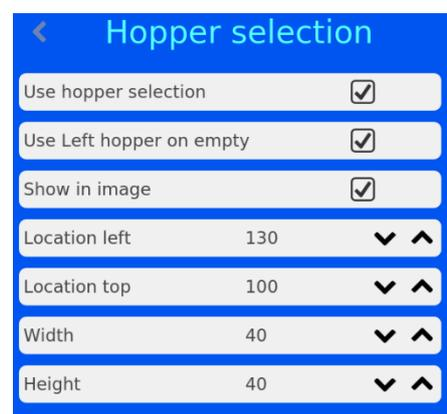
contenu de cette zone. Pour activer la sélection intelligente des lames, il suffit de cocher la case en regard de l'option Utiliser la sélection du chargeur.
