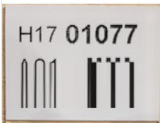
**Lignes verticales.** Les lignes verticales découlent d'un mauvais raccordement du câble nappe reliant la tête d'impression à la carte de circuit imprimé.
