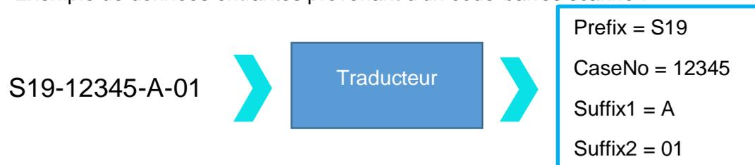
Exemple de données sortantes utilisées pour créer un code-barres imprimé :
