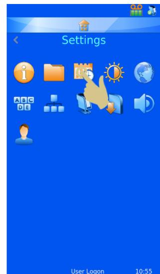
Si l'imprimante est connectée à un réseau ou à un PC, il est recommandé de sélectionner l'option UTILISER L'HEURE DU RÉSEAU. L'imprimante sera ainsi synchronisée avec les autres systèmes présents dans le laboratoire.
